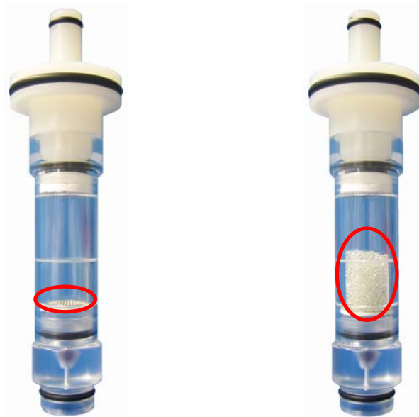
Abbildung 39: Zellbeschickung der in Ph.Eur. 2.9.49. monographierten Pulver-/Granulatzelle. Auf der linken Seite die Pulver-/Granulatzelle ohne Glasperlen und auf der rechten Seite die Pulver-/Granulatzelle mit 2 g Glasperlen. Der rote Kreis gibt an, in welchem Bereich in der Zelle der Wirkstoff verteilt vorliegt.
