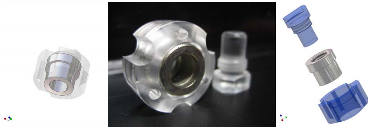
Abbildung 86: Zelleinsatz zur Intrinsic Dissolution in Durchflussszellen, passend für die monographierte Tablettenzelle (22,6 mm).
